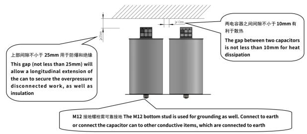
电容主要是通过底部螺栓安装固定, 若需要其它安装固定方式, 请联系我司技术人员确认。
