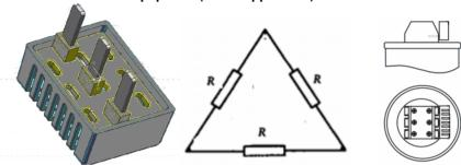
C6S 帽式设计电容器系列有可选配的放电电阻, 其配套的放电电阻能满足在 3min 内使电容器放电到 75V 或更低电压, 放电电阻值的计 算可以按如下公式:
